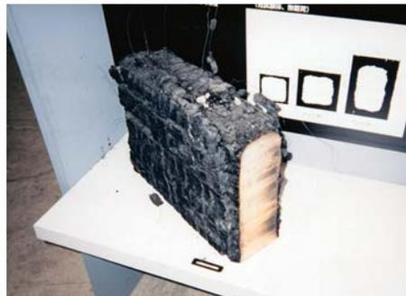
木材でも太い材料は火に強いことが実証されています。これは燃えた部分に炭火層が形成され、酸素の供給が遮断されるためです。大断面木材ではこのような特性を考慮して燃えしろ設計がなされ、構造計算がされています。
