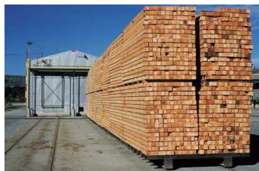
木材乾燥設備
